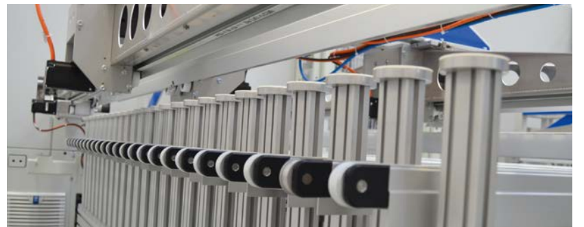
Modulkonzept: 24 BRECO®-Zahnriemen, 48 Endköpfe mit Riemenscheiben, 12 Aluminium-Profile, 24 Kupplungen verbinden 12 Antriebswellen mit dem Antriebsmotor.
