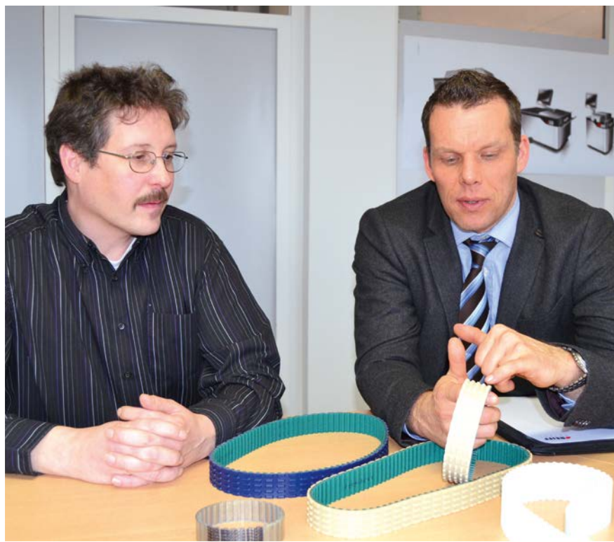
Alle Zahnriemen für die Schneidmaschinen auf einen Blick: Der weiße ist doppelt verzahnt und dient als Hauptantrieb. Der kleine silberne koppelt die Riementreiber der zwei beschichteten Zahnriemen. Volker Helle (links) und Rainer Müller kennen alle Details dieser ausgeklügelten Zahnriemen.
