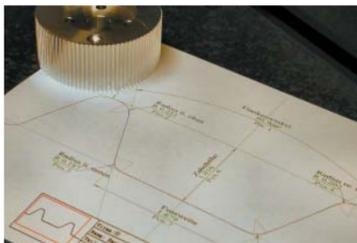
Qualitätskontrolle auf 1/1000 Millimeter genau: das Conturoscopverfahren.
