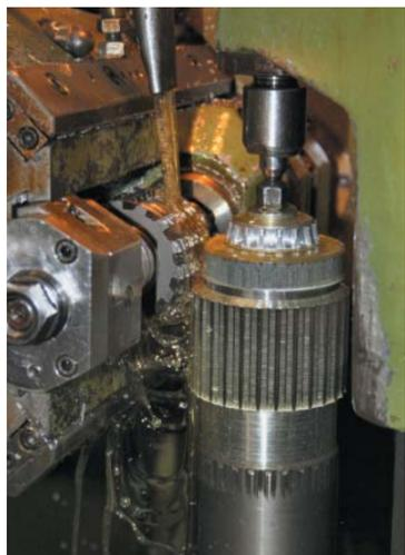
Entstehung einer AT 10 Synchronscheibe mittels Abwälzfräsen.
