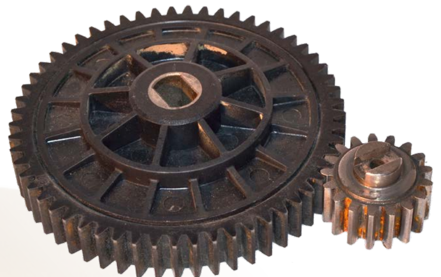
Verschleißanfälligkeit und unangenehme Geräuscentwicklung: der serienmäßig eingesetzte Stirnradatz.
