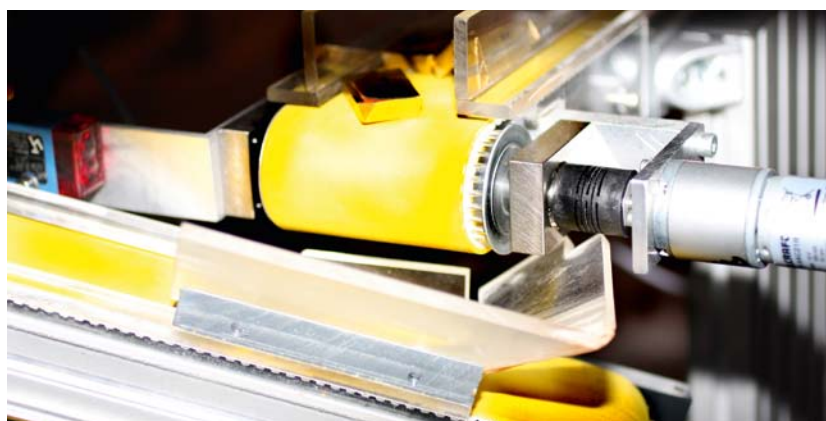
BRECO® AT5-Zahnriemen im Einsatz. Die Schokoladentäfelchen aus dem unterirdischen Depot liegen separiert auf dem per Lichtschranke gesteuerten Separierungsband und fallen einzeln bei Abruf per Taste auf das Transportband zur Ausgabeschale
