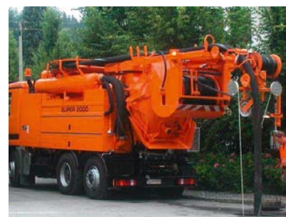
Kanalreinigung System SUPER 2000 im Einsatz
