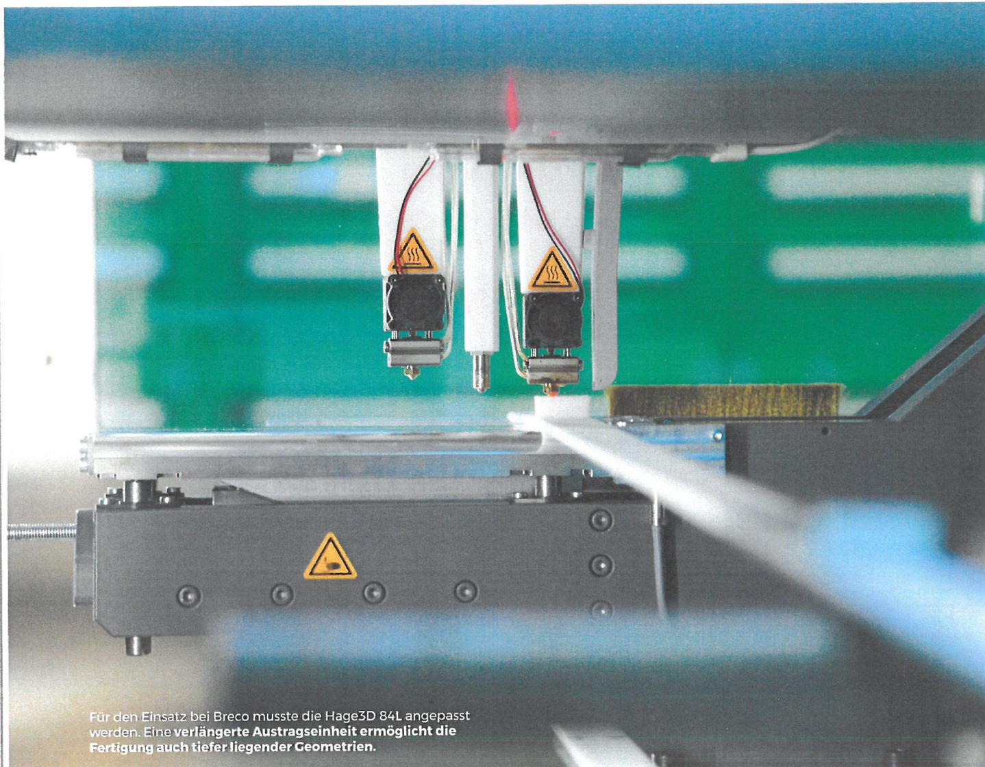
Für den Einsatz bei Breco musste die Hage3D 84L angepasst werden. Eine verlängerte Austrageinheit ermöglicht die Fertigung auch tiefer liegender Geometrien.
