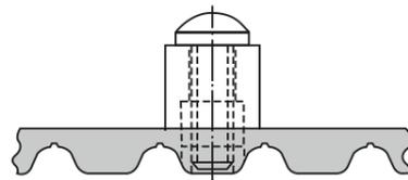
Anschlussgeometrie ATN10 / ATN10K6 / ATN 12,7 / ATN12,7K6 (Schnitt durch Riemenzahn)
